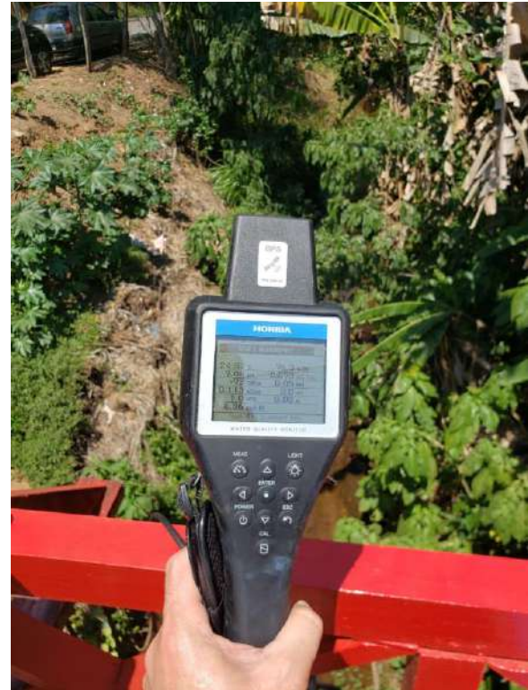
Figura 3. Coleta de água para análise laboratorial e sonda multiparâmetros para Monitoramento de rios da Região Hidrográfica Piabanha (RH-IV).
