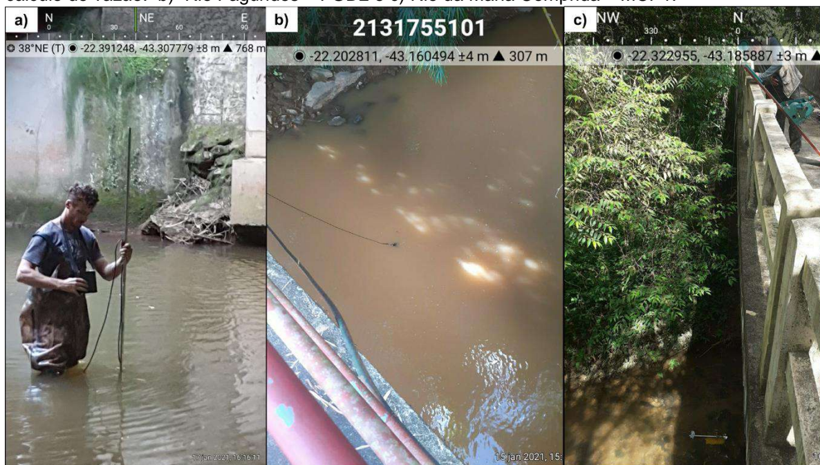
Figura 77. Rios da sub-bacia Fagundes. a) Rio Fagundes – FGD1 durante o uso do molinete para o cálculo de vazão. b) Rio Fagundes – FGD2 e c) Rio da Maria Comprida – MCP1.
