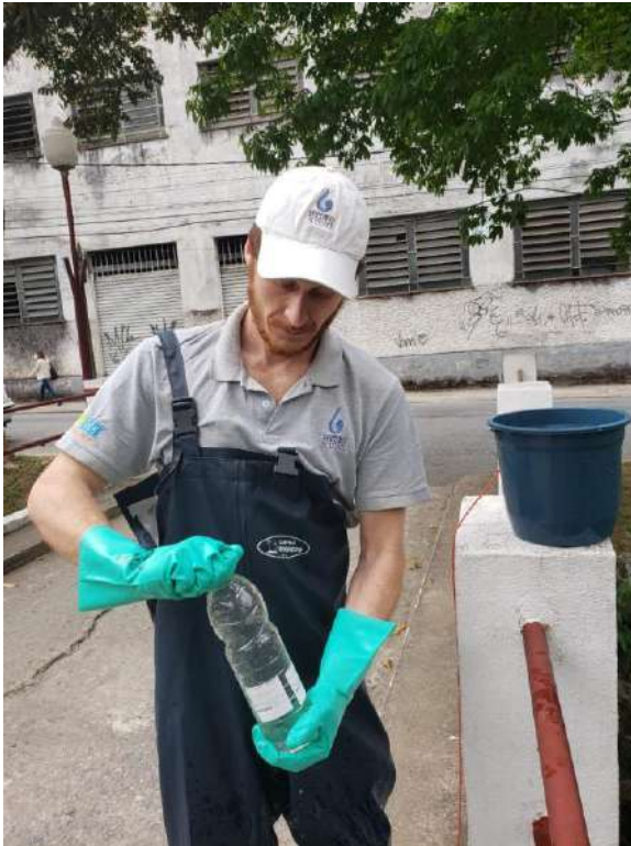
Figura 3. Coleta de água para análise laboratorial e sonda multiparâmetros para Monitoramento de rios da Região Hidrográfica Piabanha (RH-IV).
