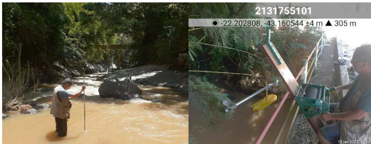
Figura 6. Medições de fluxo com molinete operado em haste a vau (esq.) e operado com guincho fluviométrico e lastro (dir.).
